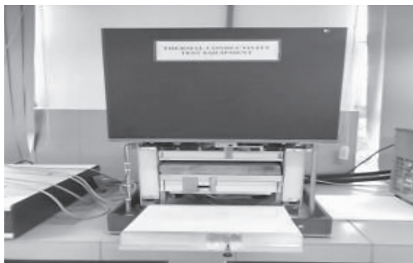
Hình 22. Thiết lập thử nghiệm Unitherm Model 6000. Dụng cụ tản nhiệt được bảo vệ [11]
