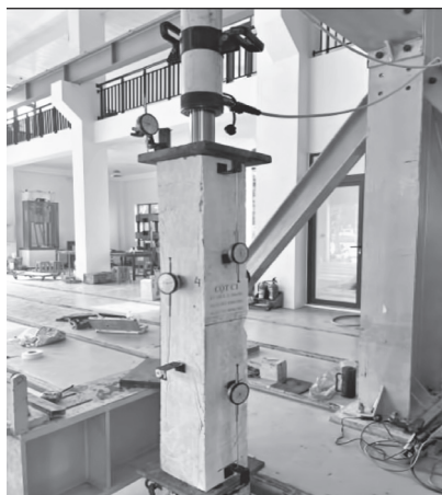
Hình 29. Mô hình thí nghiệm cột được đề xuất
